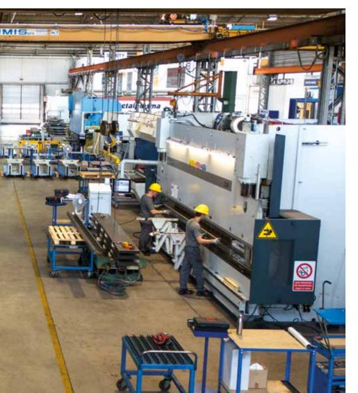
Metalplasma offre servizi di pressopiegatura che raggiungono una forza di pressione fino a 3.200 ton su lunghezze fino a 17 mt. L'altissima precisione delle operazioni di piegatura consente di assemblare
